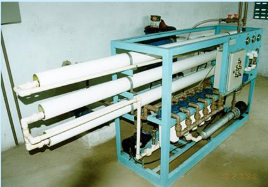
Dessalinizador por osmose reversa
