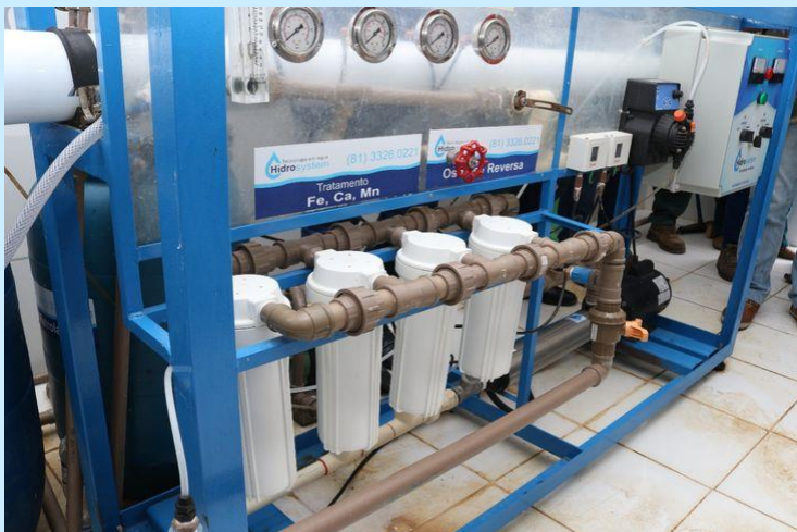
Dessalinizador, com membranas de osmose reversa
